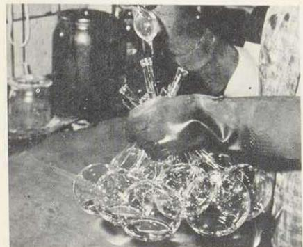
Die Kugeln werden durch Einträufeln von Silbernitrat zum Verspiegeln vorbereitet. Damit sich die Silberlösung innen gut anlegt, kommen sie anschließend in einen Bottich mit heißem Wasser. Hierbei entstehende Dämpfe erschweren den Vorgang. Zum Schutz der Hände trägt die Arbeiterin Gummihandschuhe
