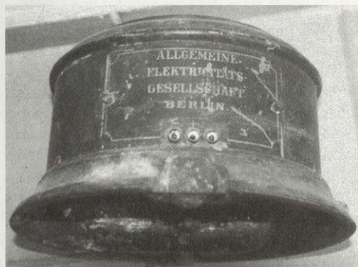
Abb. 1 u. 2: Stromzähler der Allgemeinen Elektrizitätsgesellschaft Berlin aus der Brauerei Sippel Baunach, bis 1927 in Gebrauch.
