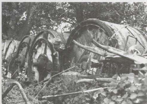
Abb. 2: Ausgebaute, im Hof lagernde Walkfässer der Glacé Lederfabrik im Jahr 1947; aus: StAW, Finanzamt Würzburg, Vermögenskontrollakten 3522.
