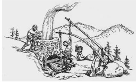
Abb. 4: Skizze eines frühmittelalterlichen Rennofens mit fußgetriebenen Blasebälgen (aus: Mathias Döring: Eisen und Silber – Wasser und Wald: Gruben, Hütten und Hammerwerke im Bergbaurevier Müsen. 1999, S. 164).
