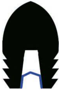
Abb. 1: Minié Projektil mit Culot. Eigener
