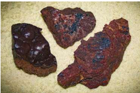
Abb. 1: Roteisenerze (Hämatit) von Suhl (Kütebahn, Döllberg): Roter Glaskopf (l.) und Eisenglimmer auf derbem Roteisenstein mit Gangarten.
