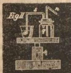
Das Rohr *n* desselben wird in das Rohr *d* des Apparats (*Fig. I*) geschoben und mittelst nasser Blasen und Bindfaden befestigt. In das Gläschen *q* kommt die Flüssigkeit, welche der Wirkung des am Platinblech des Apparats (*Fig. I*) galvanisch ausgeschiedenen Gases ausgesetzt werden soll. Die Flüssigkeit *a* im zweiten Gläschen ist Wasser und dient dazu den Zutritt der atmosphärischen Luft abzuhalten, in den Fällen, in welchen es nothwendig ist.
