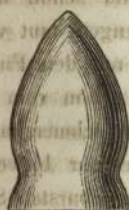
Cylindrokönisches Hohlgeschoss der dänischen Miniégewehre, wie sie die neuen Bataillone haben sollen.
