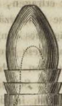
Massives einmal cannelirtes Spitzgeschoss der geriffelten dänischen Muskete.
